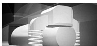
Рис. 8. 3D-візуалізація штифта, який приводиться в дію електромоторчиком
