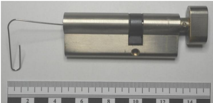
Рис. 1. Загальний вигляд циліндрового механізму з вставленою скріпкою
