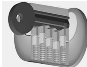
Рис. 3. Загальний вигляд циліндрового механізму з вставленим неправильним ключем (вид в розрізі)
