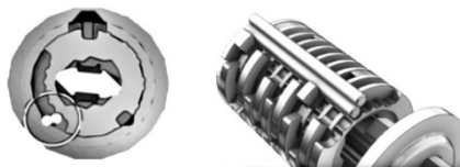
Рис. 4, рис. 5. Схематичне зображення прокручування циліндру в корпусі механізму (вид в розрізі та збоку)
