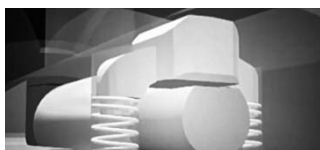
Рис. 8. 3D-візуалізація штифта, який приводиться в дію електромоторчиком
