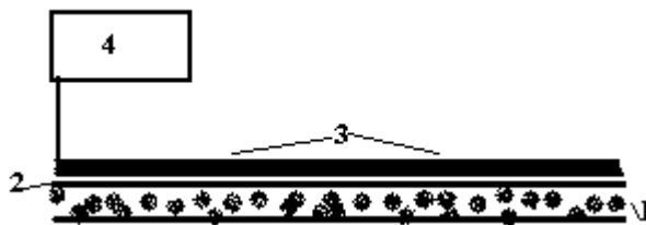
Рис. 1. Схема вимірювальної установки: 1 – композиція; 2 – мембрана; 3 – електрод; 4 – вольтметр
