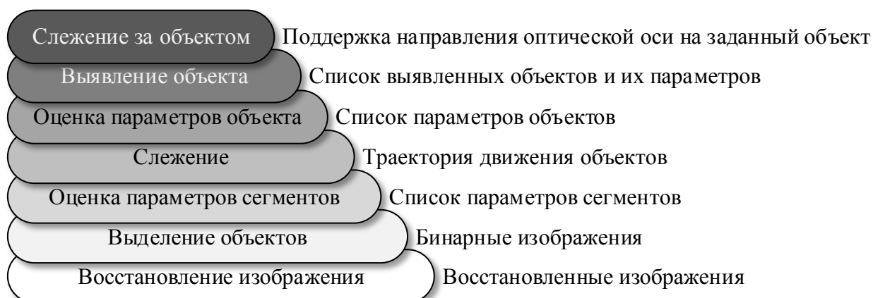
Рис. 2. Иерархия уровней обработки видеопотока для детектора слежения
