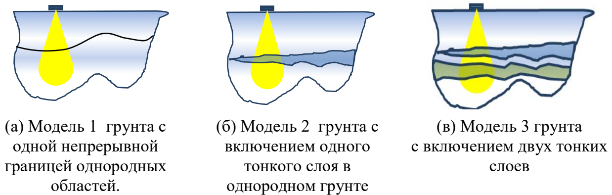
Рис. 1. Модели слоистых грунтов при анализе данных георадарных измерений
