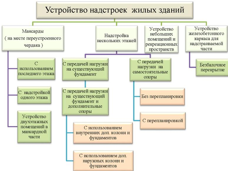
**Рис. 1. Классификация устройства надстроек**
