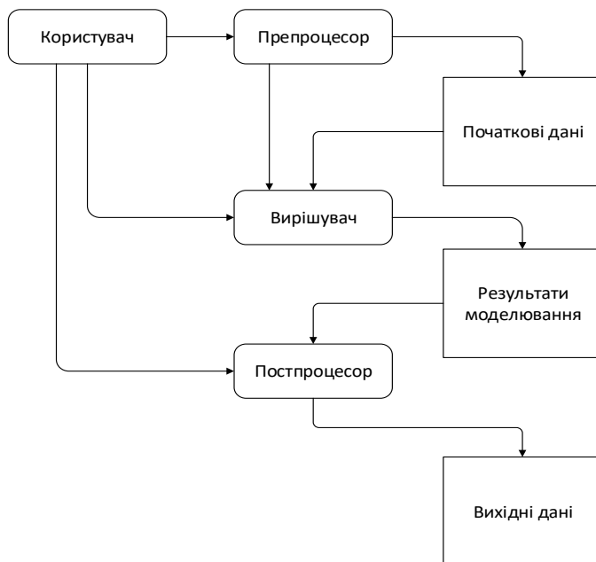
Рис. 1. Діаграма роботи користувача та інформаційні потоки в системі підтримки прийняття рішень
