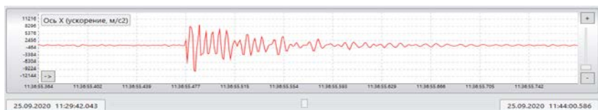
Рис. 2. Сигнал тріщини в шахті ЗЖРК
