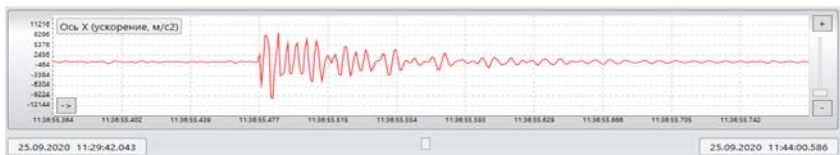
Рис. 2. Сигнал тріщини в шахті ЗЖРК
