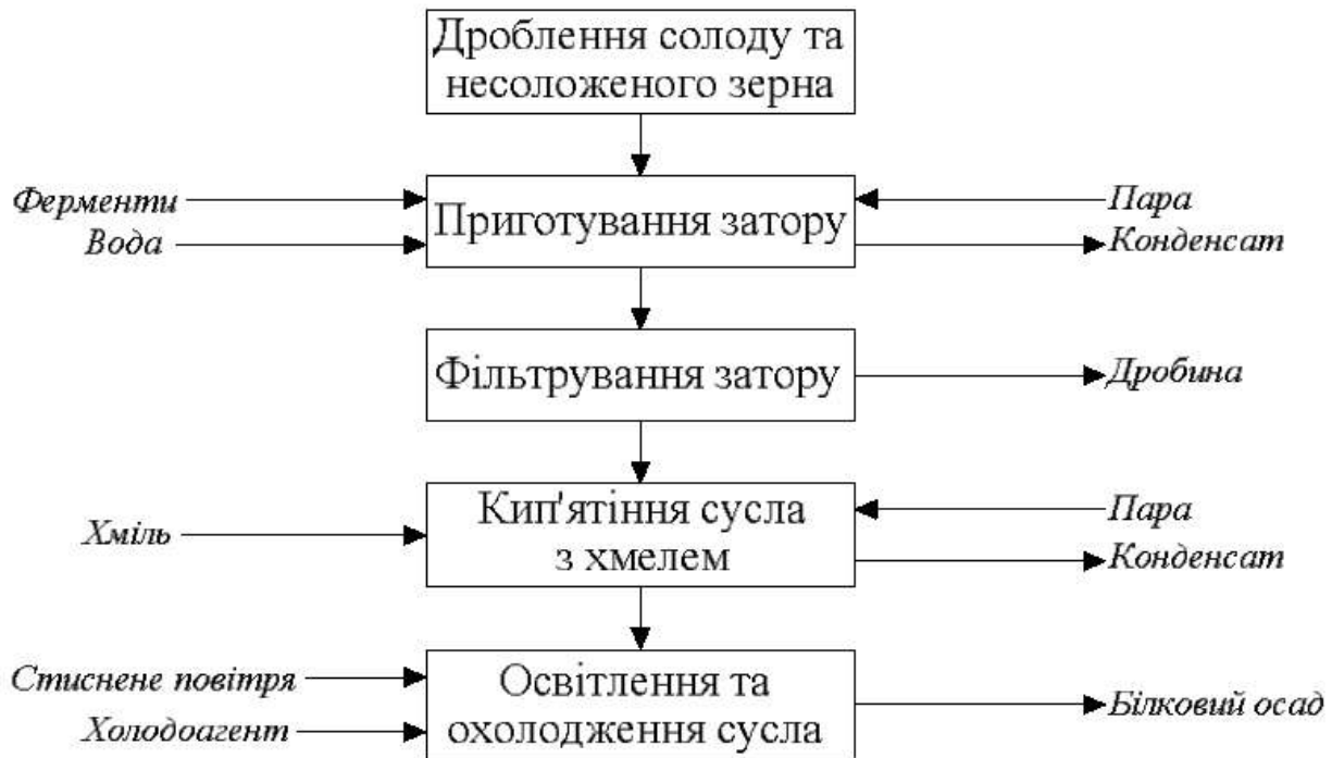
Рис. 1. Принципова технологічна схема виробництва сусла Джерело: розробка авторів
