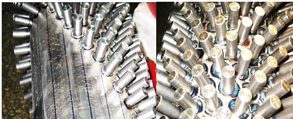
Рис. 3. Фрагменти труби (15X5M) з навареними шипами (сталь 20)
