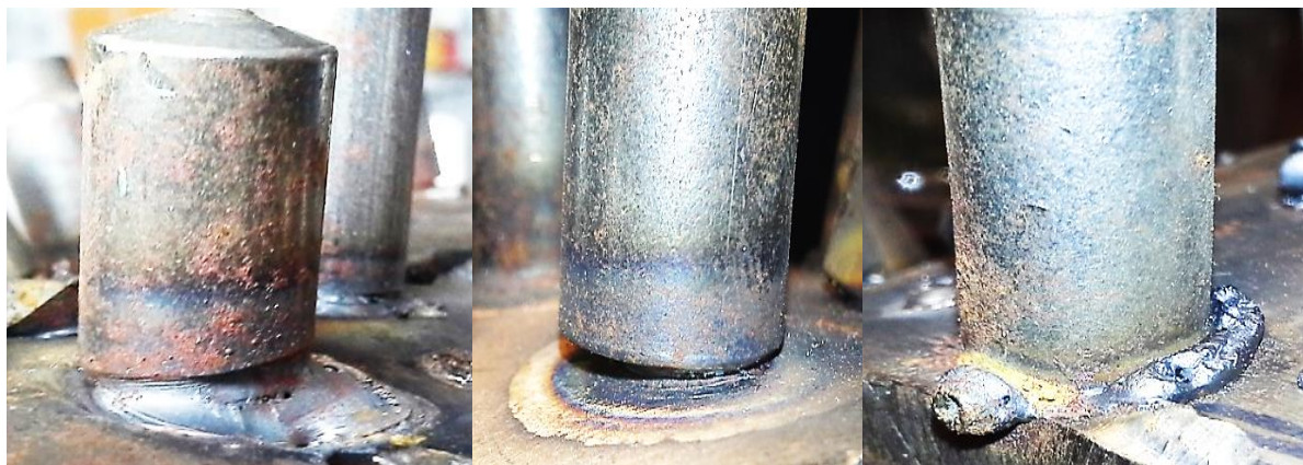
Рис. 2. Фрагменти зварних з'єднань шип (сталь 20) – труба (сталь 15X5M), при порушенні режимів зварювання: а) формування не щільної галтелі (підріз); б) виплески рідкого металу, та нерівномірність формування галтелі
