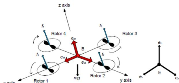
**Рис. 1. Схематическая структура квадрокоптера и выбор системы координат**
