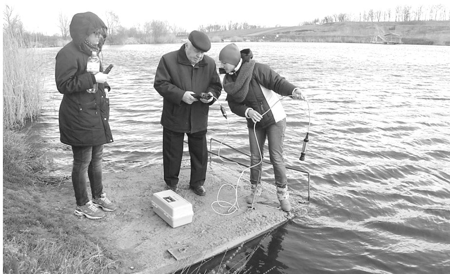
Рис. 2. Відбір проб води та експрес-проведення визначення вмісту кисню
