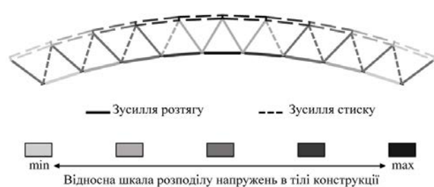
Рис. 3. Узагальнена діаграма розподілу внутрішніх зусиль від навантаження в елементах сталезалізобетонного структурно-вантового покриття для зразків прольотом 30, 36 та 42 м
