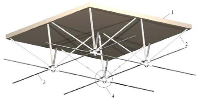
Рис. 1. Фрагмент збірного сталезалізобетонного структурно-вантового покриття 1 – армоцементна плита; 2 – елементи сталевий структурної решітки; 3 – гнучкі елементи нижнього поясу; 4 – вузол з'єднання гнучких елементів нижнього поясу
