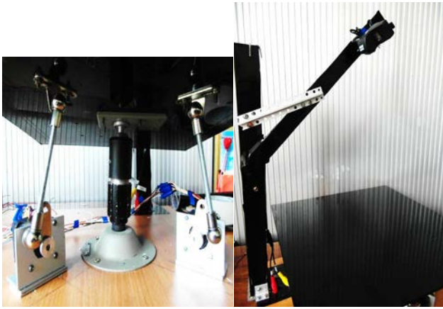
Рис. 2. Механізм керування платформою та відеокамера
