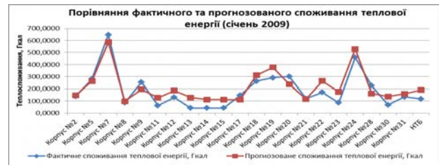
Рис. 2. Порівняння фактичного теплоспоживання із прогнозованим за моделлю (на прикладі січня 2009 р.)
