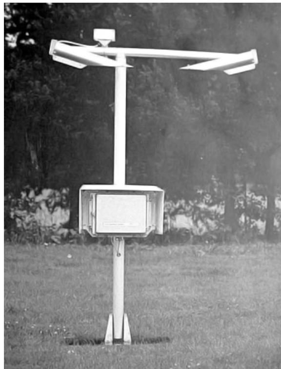
Рис. 4. Внешний вид нефелометра FD12P
