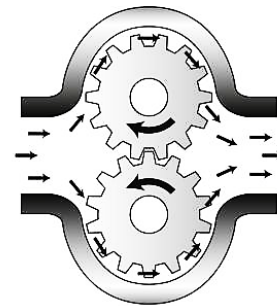
Рис. 1. Схема процесу проштовхування розплаву через шестеренний насос
