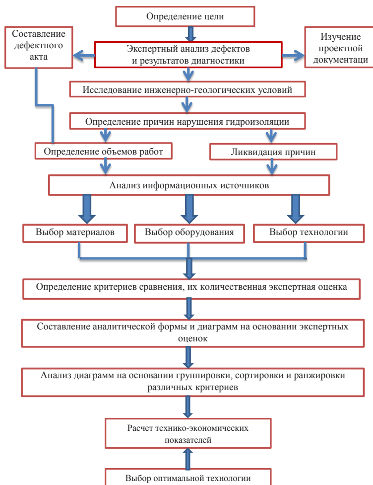
Рис. 1. Алгоритм выбора технологического решения устройства гидроизоляции на основе многокритериального анализа
