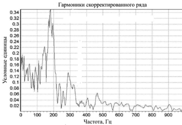
Рис. 15. Частотные характеристики собственных колебаний стэнда
