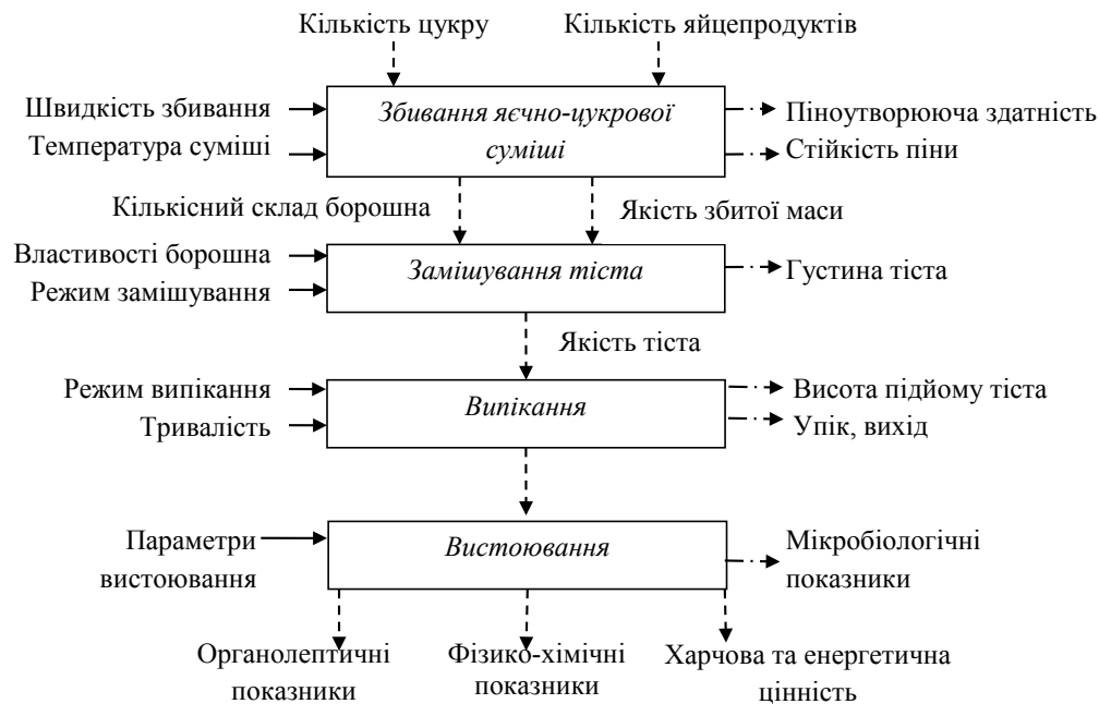
Рис. 3. Параметрична модель технологічної схеми виробництва бісквітного напівфабрикату з використанням мультизернового борошна: → – керовані параметри, ---- → – вхідні, вихідні; - - - - - → – контрольовані
