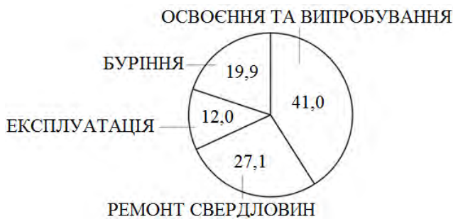
Рис. 4. Співвідношення об'ємів технологічних процесів з використанням свердловинних струминних насосів
