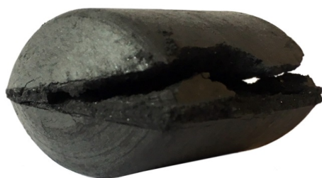
Рис. 3. Приклад розшарування брикетів у площині поділу, агрегованих у симетричних системах ущільнення валкових пресів
