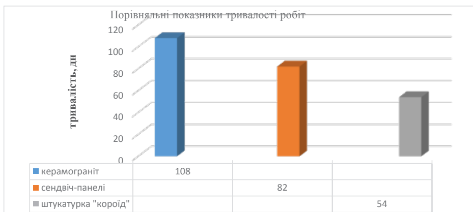
Рис. 7.2. Порівняльні показники трьох варіантів влаштування утеплення стін
