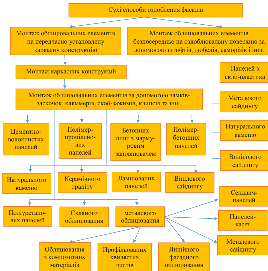
Рис. 1. Класифікація сухих способів оздоблення фасадів
