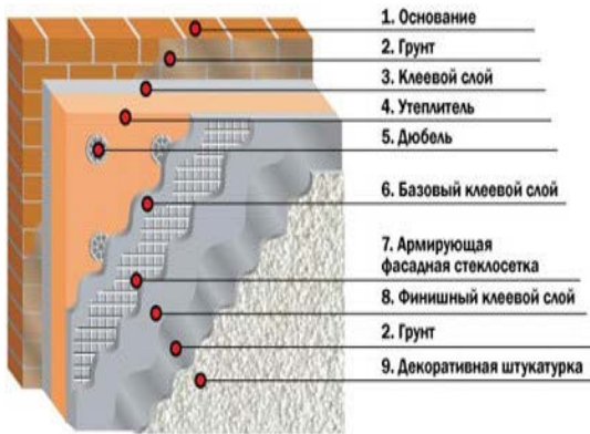
Рис. 6. Утеплення фасаду штукатуркою «короїд»
