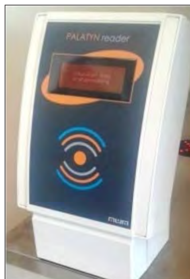
Rys. 2. Czytnik kontroli przejścia
