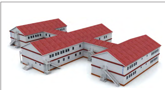
Рис. 4. Об'ємно-просторова схема формування модульного дитячого садка із блок-контейнерів
