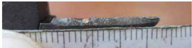
Рис. 5. Збільшене зображення правого різця кусачок
