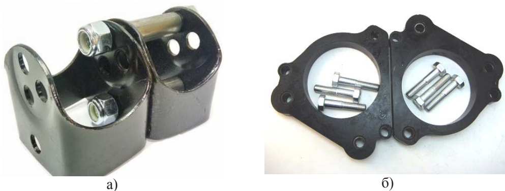
Рис. 2. Вигляд варіанту додаткових елементів, що використовують для збільшення дорожнього просвіту автомобіля: а) – для задньої осі; б) – для передньої осі [2]
