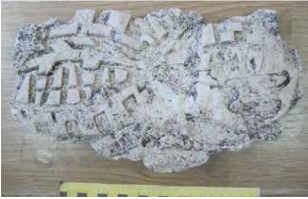
Рис. 1. Слід низу підошви взуття, зафіксований за допомогою гіпсового зліпку, що наданий на дослідження
